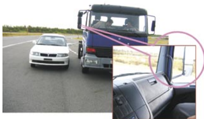
圖3V 大型車的視角盲點比小型車廣且多，圖中的汽車(也可能是機車或行人)位於大型車駕駛人之視野盲點內，因此行駛在其左右側或位於轉彎側向動線上均相當危險。
