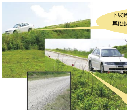
圖3I 下坡路段，由於車姿呈前重後輕，可能稍微用點煞車就會造成後輪鎖死進而甩尾失控（無ABS）。如路面為碎石子時更易發生此種情況。
